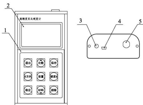
1 按键区    2 显示区    3 ON/OFF 键    4 USB 通讯插座    5 冲击装置插座
