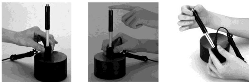
表面，将 DC 型冲击装置插入加载杆，直到停止位置为止，此时就完成了加载。
